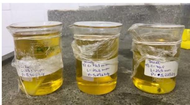
**Figura 2.** Corpos de prova submersos em Óleo Diesel.
